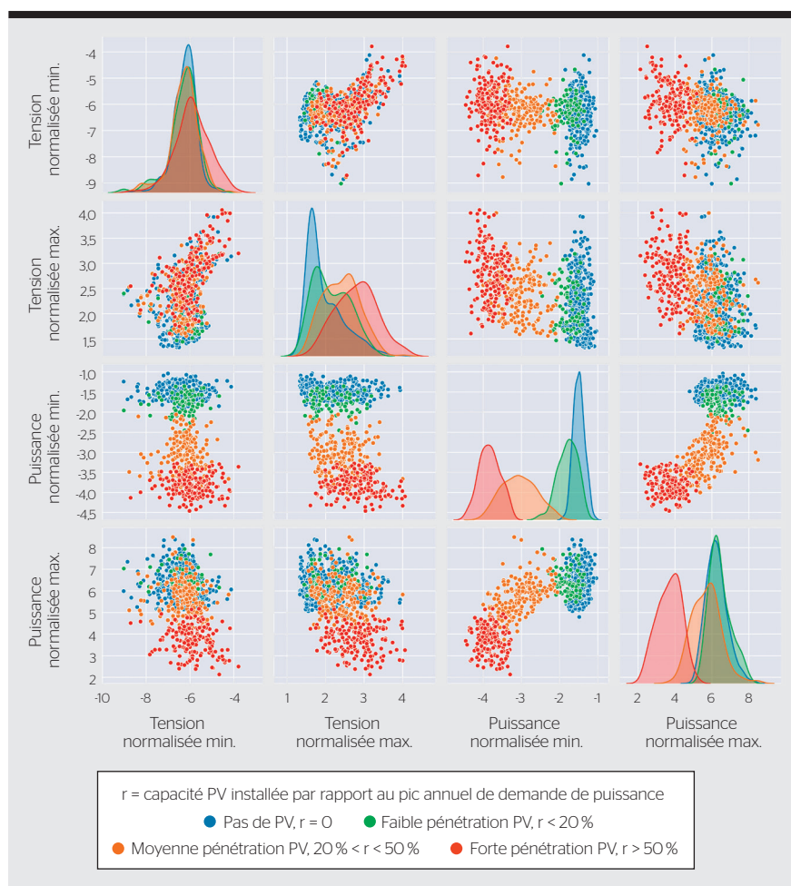
Figure 2 Exemple de caractéristiques significatives (minimum/maximum annuels de la tension et de la puissance normalisés) pour la classification des 729 nœuds d'un réseau électrique simulé en fonction de la capacité photovoltaïque installée. Chaque point représente les séries temporelles des tensions et puissances de consommation normalisées d'un nœud du réseau pendant un an.
