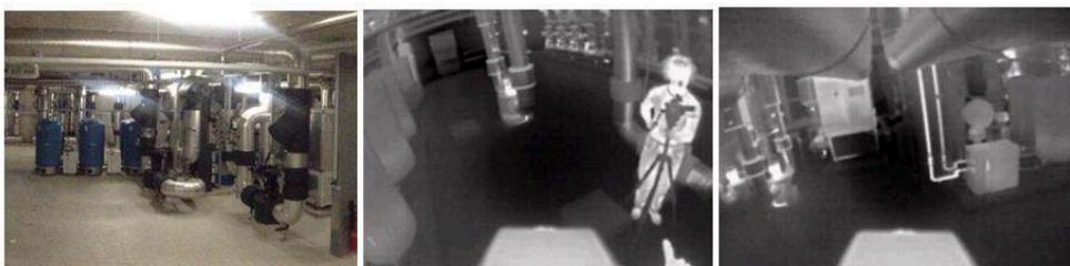
À gauche : salle de test en pleine lumière (image visible), au centre et à droite : obstacles et individu dans le champ visuel en semi-obscurité (image thermique)
