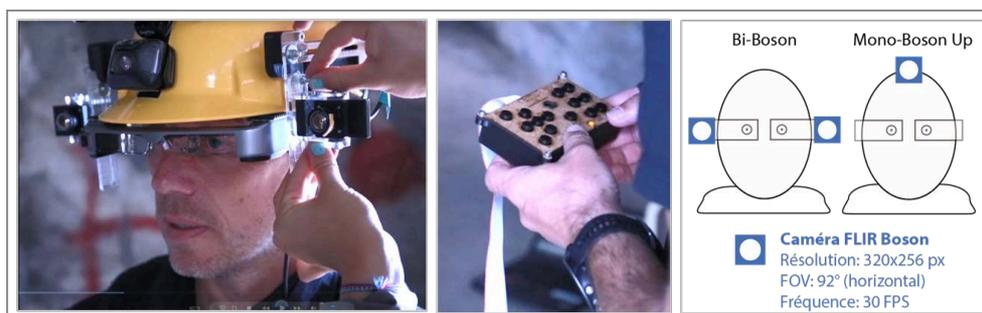
(à gauche et centre : système embarqué sur casque et boîtier de contrôle ; à droite les deux configurations testées).
