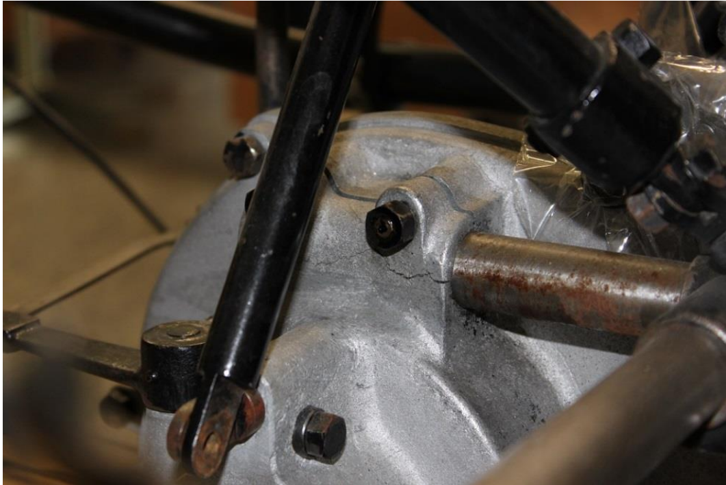
Des fissures traversantes s'étendent sur toute la partie haute du carter. (HE-Arc CR)
