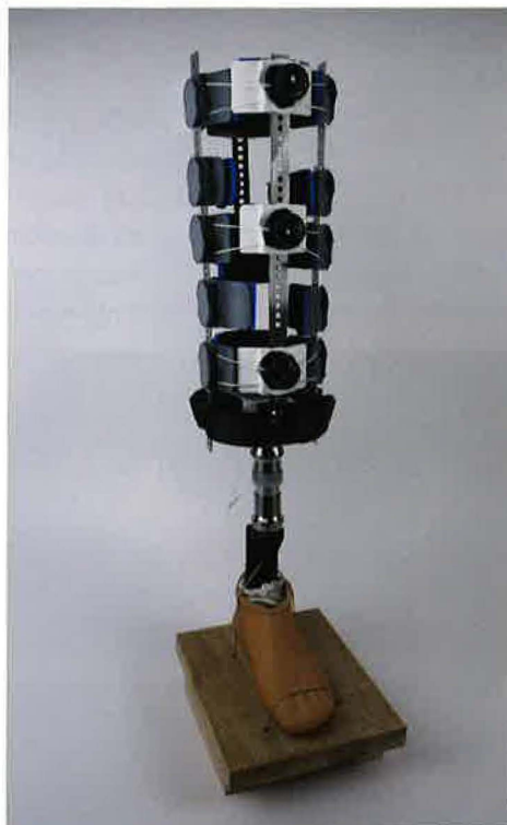
Abbildung 5: Foto des Prototyps des entwickelten AXO-Schafts und Standard-Fussprothese (Fuss und Rohr)
