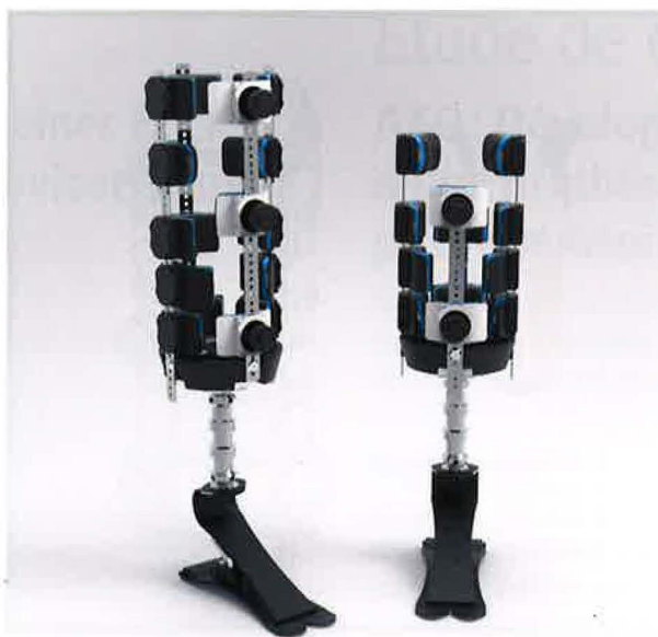
Abbildung 4: 3D-Darstellung. Links: AXO-Prothese mit fixiertem Kniegelenk, rechts: AXO-Prothese mit nicht fixiertem Kniegelenk Figure 4: Rendu 3D. A gauche, prothèse AXO genou bloqué, à droite prothèse AXO genou libre
