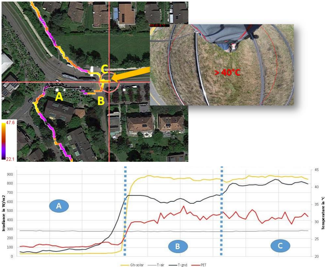
Fig. 16: La température de surface ( T_{\text{grd}} ) des pelouses soumises à un stress hydrique ( 41^{\circ}\text{C} : secteur C) est supérieure à la température de l'asphalte adjacent ( 39^{\circ}\text{C} : secteur B). Le secteur A se trouve ombragé par une rangée d'arbres (Bâle 04-08-16)
