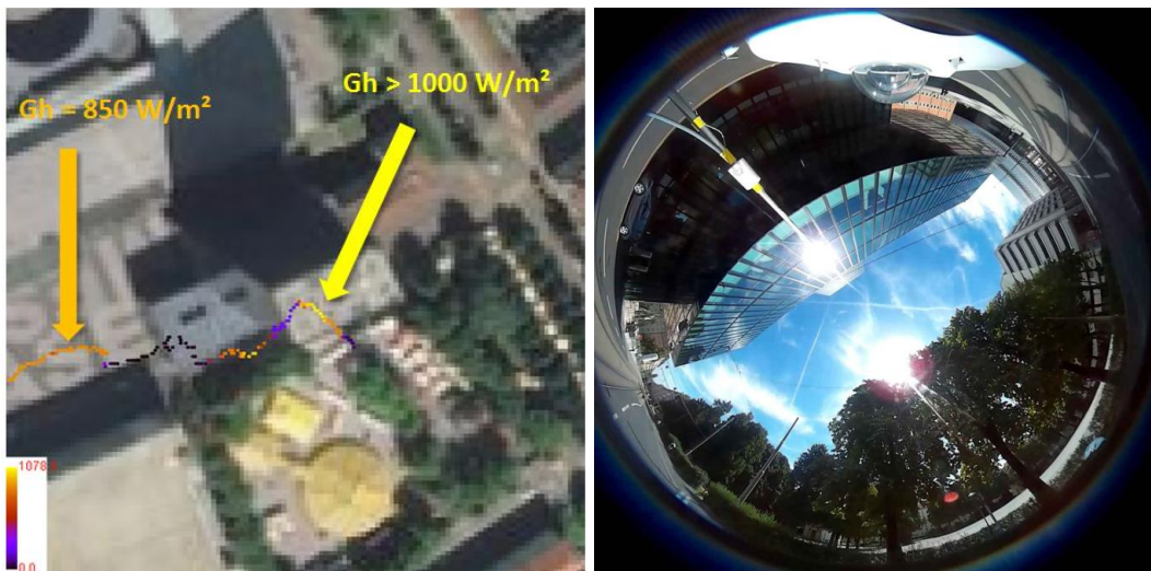
Fig. 14: Réflexions et effets de miroir sur les façades vitrées. Gh = rayonnement solaire global horizontal; sur la place, le rayonnement solaire incident est de 850 W/m²; devant la façade réfléchissante (image de droite), le rayonnement s'élève à plus de 1000 W/m². (Bâle 04-08-16)
