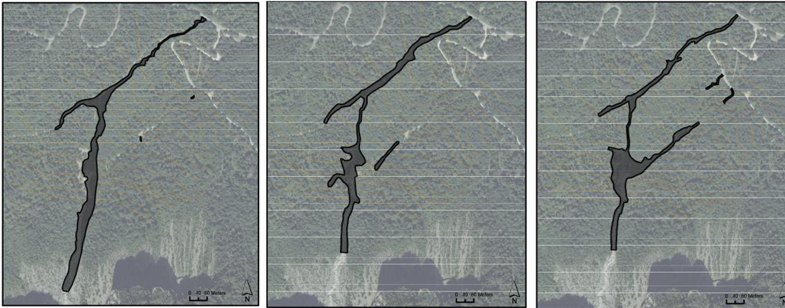
Figure 8 : Exemple de l'évolution de la limite de la bande active (trame grise) en 1982, 2006 et 2009 (de gauche à droite).
