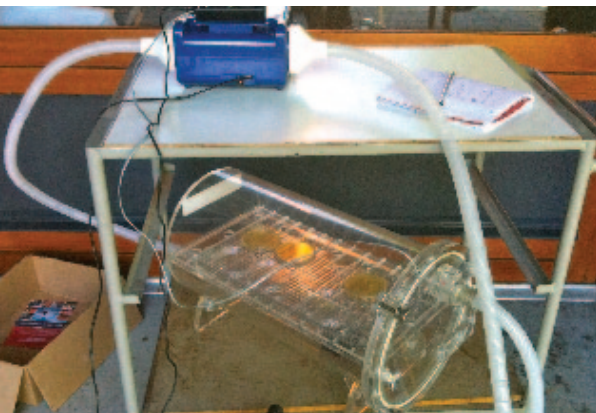
Figure 3. Installation de désinfection des boîtes de Pétri à l'ozone gazeux.
