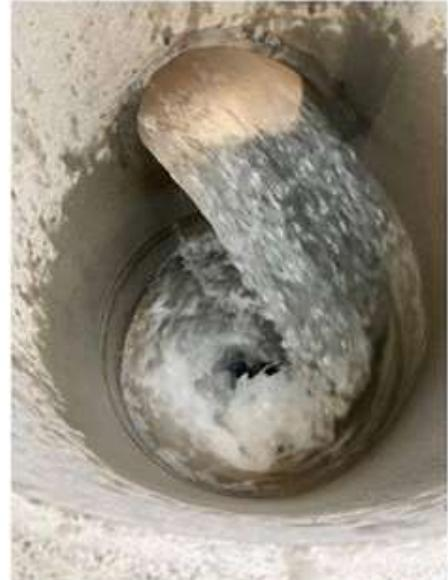
*Plot aus einer numerischen Simulation (Sébastien Gilliland, HEIA-FR) und Rotationsströmung beim Schachtkopf im Prototyp (EPFL)*
