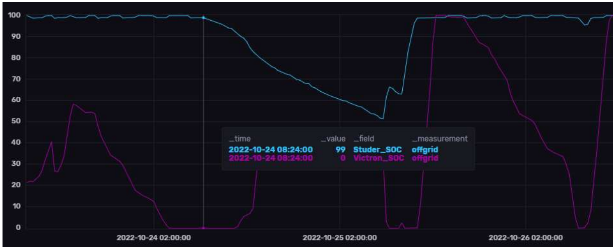
Figure 29 : Evolution SOC Studer XTender et Victron sur le site de développement Off-grid (avant mise en place algorithme)
