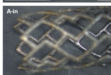
■ Fig. 7 : Macrographies montrant l'effet de l'électropolissage sur l'extérieur (A et B_out) et l'intérieur (A et B_in) des stents.
