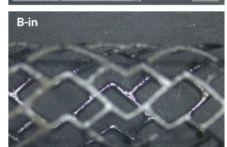
■ Fig. 7 : Macrographies montrant l'effet de l'électropolissage sur l'extérieur (A et B_out) et l'intérieur (A et B_in) des stents.
