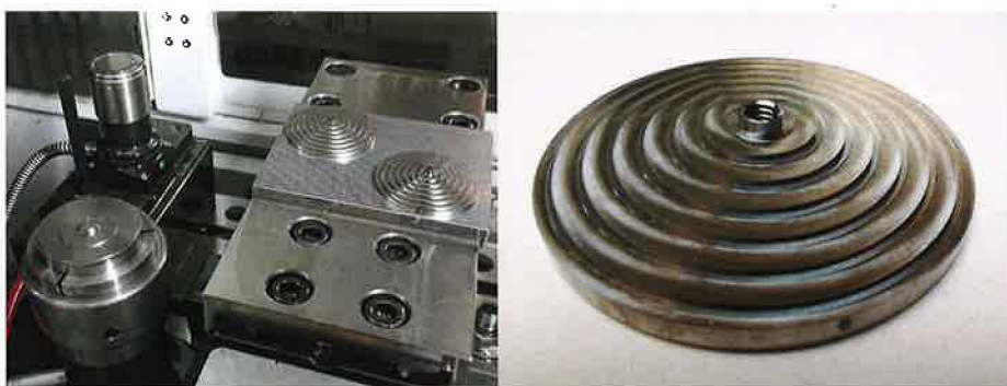
■ Fig. 3. Le banc de test d'usinage avec les éprouvettes usinées.
