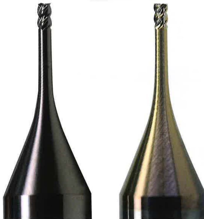
Fig. 1. Les micro-fraises de Louis Bélet sans revêtement (à gauche) et revêtues (à droite).
