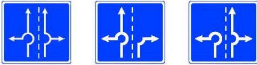
Fig. 51 Exemples de signaux « Indicateur de direction avec répartition des voies pour turbo-giratoires » [28].
