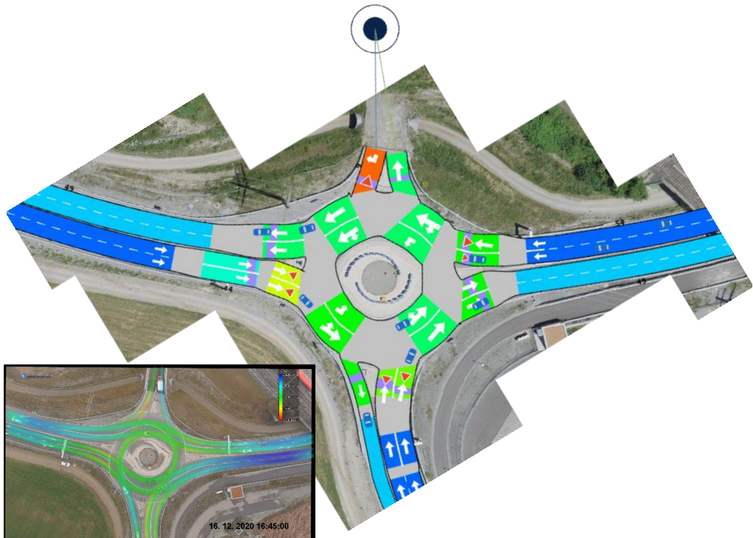
Fig. 30 Vitesse moyenne simulée et mesurée (encart) entre 15 : 00 et 16 : 45 le 16.12.2020.
