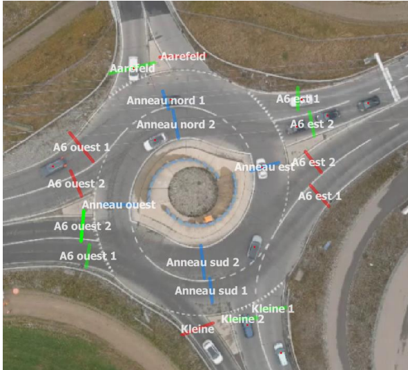
Fig. 19 Emplacements des compteurs virtuels, Glättimüli.
