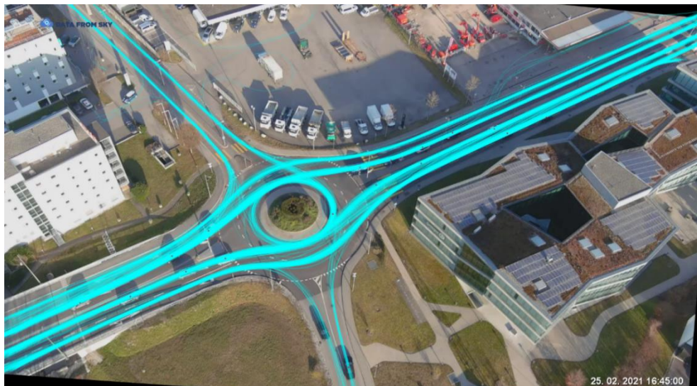
Fig. 67 Lavapesson – Giratoire conventionnel – Traces des usagers, traitement à l'aide de DataFromSky.
