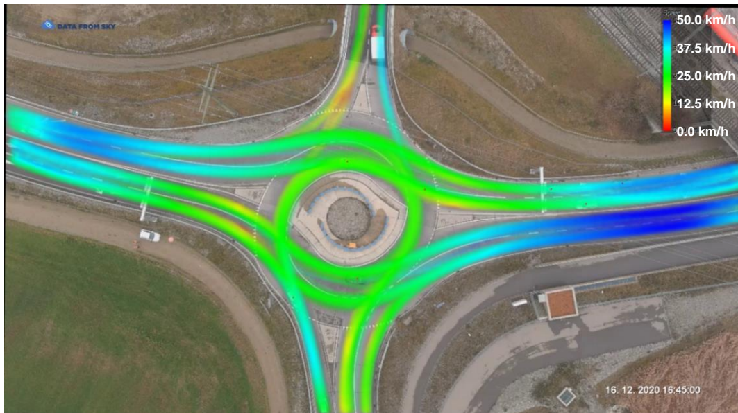
Fig. 56 Glättimüli – Vitesses, traitement à l'aide de DataFromSky.
