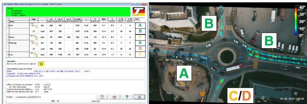
Fig. 104 Lavapesson – Niveau de service – Turbo-Kreisverkehr 2015.
