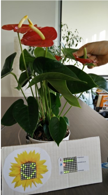
Figure 1. Le prototype développé pour le projet EmotiPlant. Quand l'utilisateur touche la plante, l'émoticône devient très contente et les valeurs de température, humidité du sol et luminosité sont affichés. La matrice LED de droite met en évidence (en rouge) les paramètres qui ne sont pas optimaux pour la nécessité de la plante.
