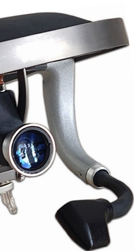
L'eye tracker, un instrument de recherche qui filme les mouvements du regard.
